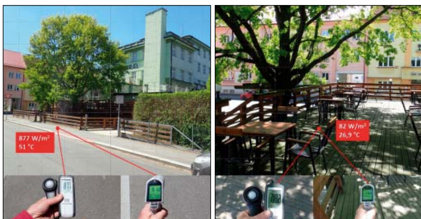
Obr. 2 a,b: Pomocí jednoduchých přístrojů na měření dopadajícího slunečního záření (přístroje vlevo) a povrchové teploty lze rychle kvantifikovat teplotní rozdíl mezi osluněným chodníkem (51 °C) a stínem stromu (26,9 °C).
